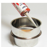
Tätning med pannkitt vid anslutning.
