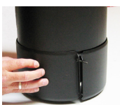
Skruva ihop, men inte hårdare än att svepet kan röras upp och ner.
